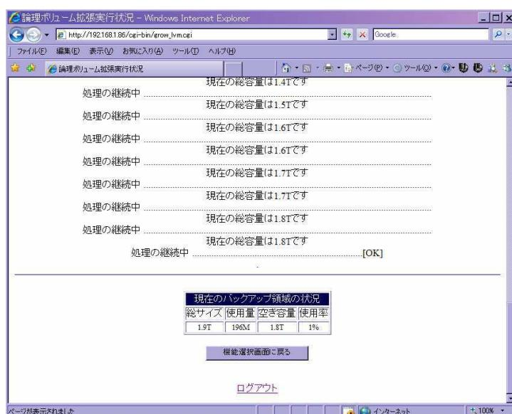
拡張に必要な全ての処理が終わると、拡張後のバックアップ領域の使用状況が表示され、その旨のメールも送信された上で、本体ブザーにより、授業開始のチャイムのような音楽が流れます。
