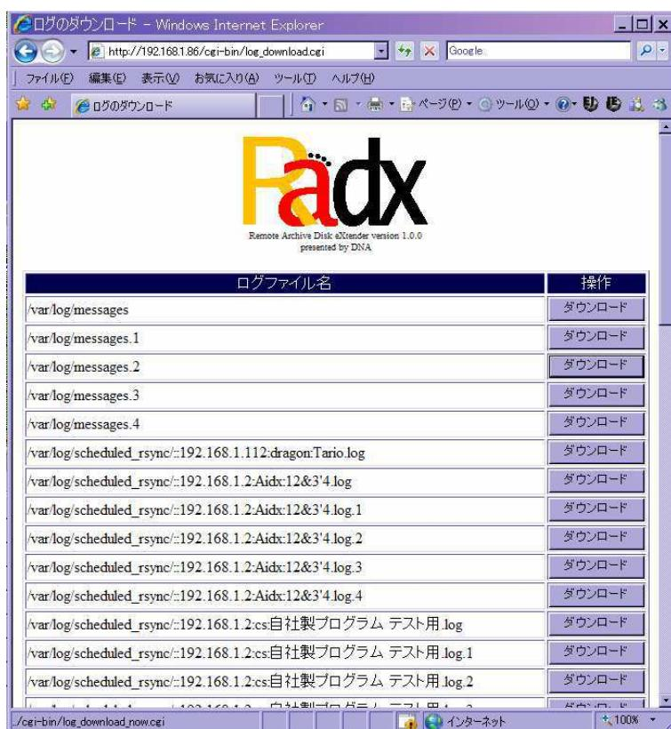
Radx では、システム的なログを /var/log/messages に出力し、個別のバックアップ元のバックアップ時のログを、/var/log/scheduled\_rsync/ の内部に出力します。検索用インデックス作成のログは、/var/www/html/log/ の内部に出力します。
