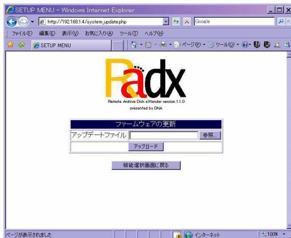
「参照...」のボタンを押すと、以下のような表示が現れますので、別途提供されたアップデートファイル（radxupX.X.Xd.zip）を選択してください。
