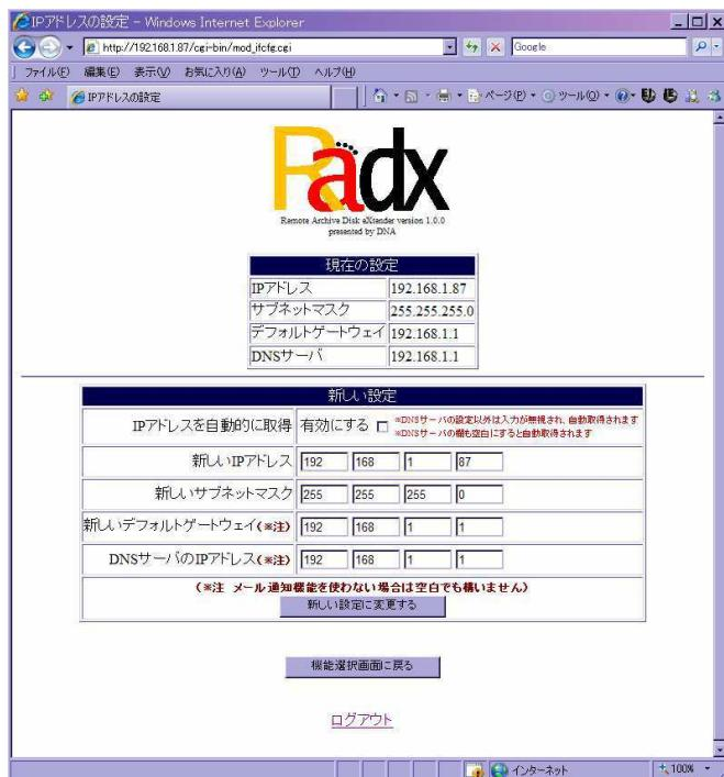
IP アドレスの設定画面では、上段に現在の設定内容が表示され、下段に、これから変更したい設定を入力できる欄が表示されます。
