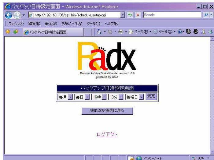
この画面では、バックアップを実行したい「月」「日」「時」「分」「曜日」を選択できます。選択後、「変更」ボタンを押すと、設定の変更が実行されます。
